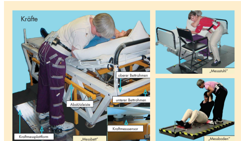
Abb. links: „Messbett“ mit zusätzlichem Bettrahmen und zwei Kraftmessplattformen (Ausschnitt: Bettecke mit Kraftmesssensor) rechts oben: „Messstuhl“, bestehend aus Krankenstuhl und Kraftmessplattform rechts unten: „Messboden“, bestehend aus zwei Kraftmessplattformen
